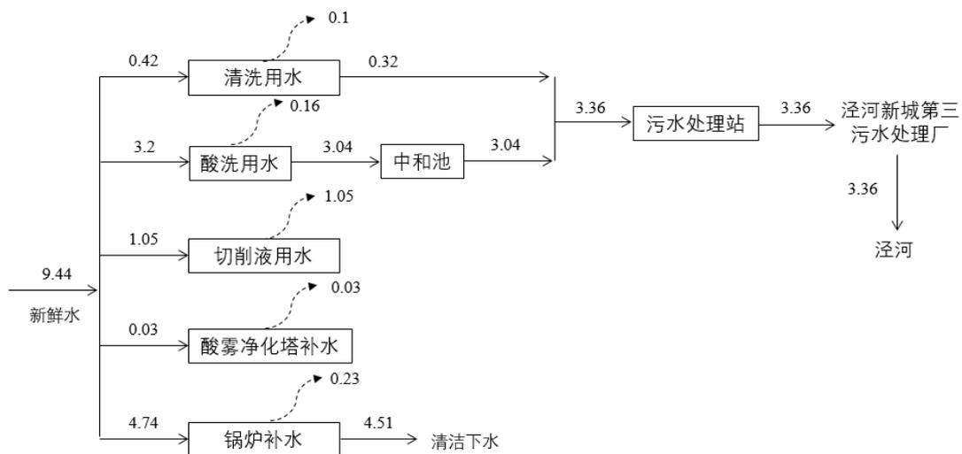
图 2-1 扩建项目水平衡示意图 (单位:  $\text{m}^3/\text{d}$ )
