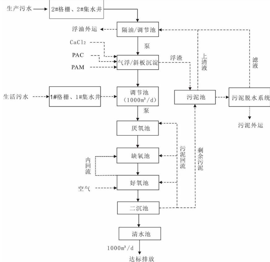
图 4-1 污水处理工艺流程图
