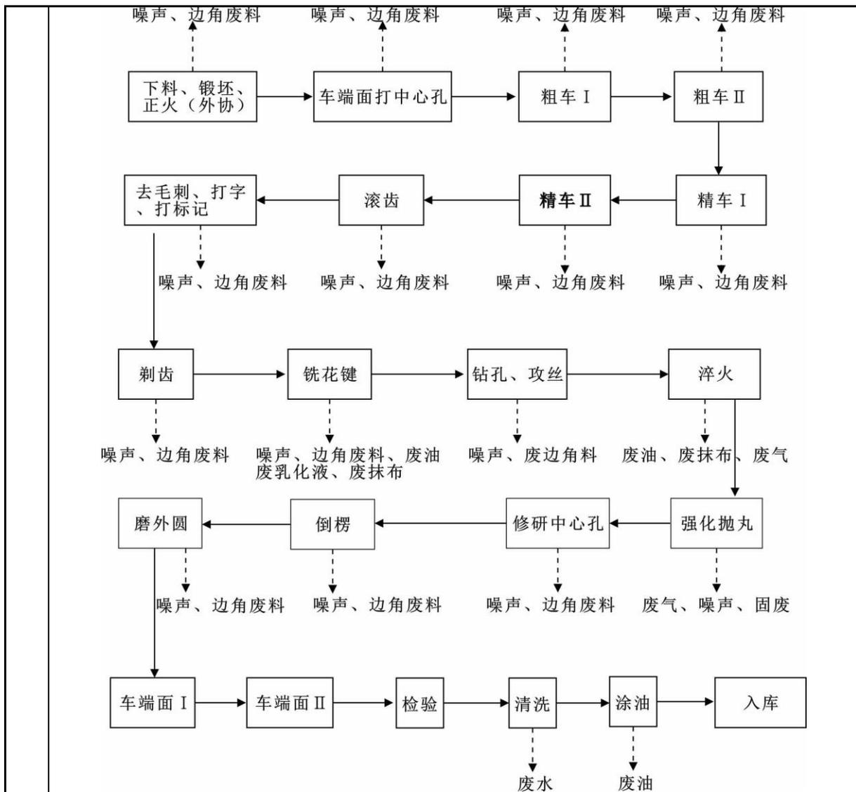
图 2-3 齿轮工艺流程分析图
