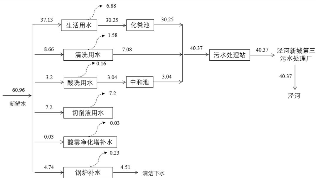
图 2-2 扩建后项目总水平衡图 (单位:  $\text{m}^3/\text{d}$ )
